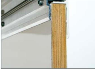
Plywood-Seitenwände mit GFK-Deckschicht, 20 mm stark
