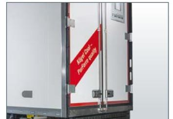
Edelstahlportal mit Drehstangen und einfach austauschbaren Scharnieren
