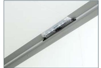
Fünf LED-Innenleuchten mit Schalter außerhalb des Aufbaus vorne links
